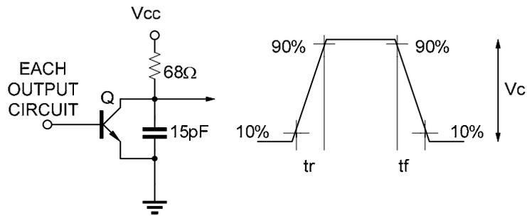
FIG. 3 COMMON-EMITTER CONFIGURATION
